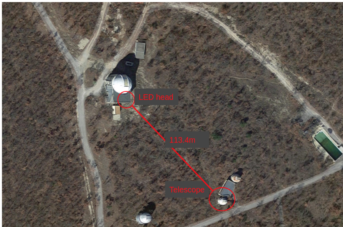
Figure 6.7 – Vue satellite de la répartition de l'équipement. Le télescope est monté à l'intérieur de la coupole en bas à droite (Jumelés). La tête de LED se situe dans le renforcement d'une fenêtre à l'étage du télescope T152 en haut à gauche de l'image. La tête de LED est orientée à l'aide d'un laser pour pointer vers la position du télescope.
