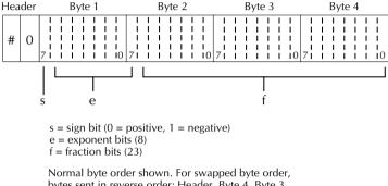
bytes sent in reverse order: Header, Byte 4, Byte 3, Byte 2, Byte 1.
