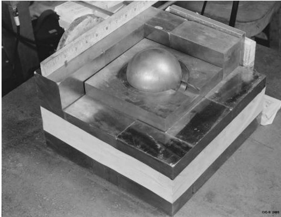
FIGURE 1 – “The Demon Core” : masse sous-critique de plutonium utilisée à Los Alamos pour les expériences liées au programme atomique US. Cette masse de plutonium devint brièvement critique à deux reprises au cours d’expériences utilisant des réflecteurs de neutrons, entraînant à chaque fois l’irradiation intense et le décès très rapide d’un physicien du projet. Cette masse de plutonium fut finalement utilisée lors d’un essai atomique sur l’Atoll de Bikini le 1er juillet 1946.
