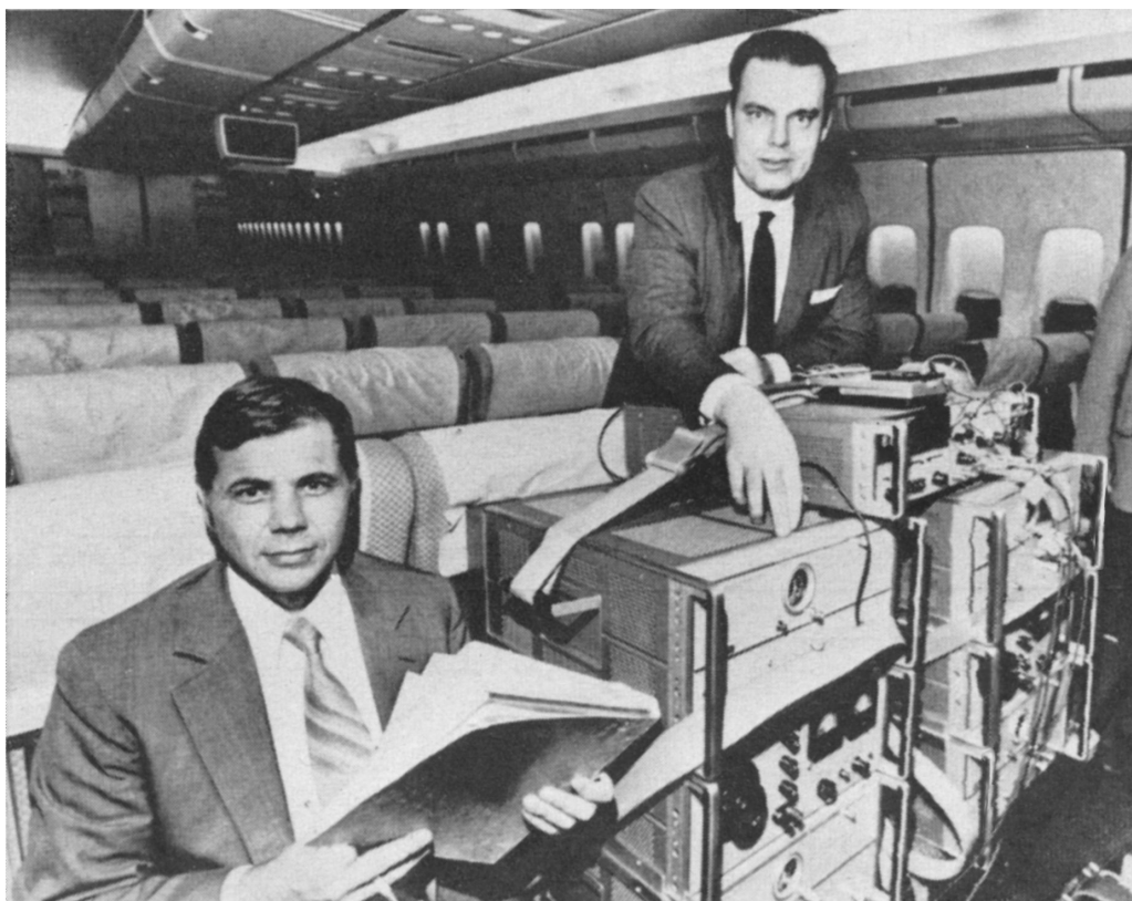
FIGURE 4 – Joseph C. Hafele (1933–2014) et Richard E. Keating (1941–2006) accompagnant " Mister Clock ", les 4 horloges atomiques au césium qui occupaient deux sièges dans l'avion. Photo prise un peu avant le départ du vol Pan American 106 de Washington à Londres [Source : Time Magazine, 18 octobre 1971].
