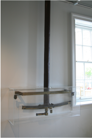
FIGURE 25 – Secteur zénithal (télescope pointant au zénith, permettant la mesure de la distance zénithale des étoiles). Conçu pour James Bradley, il est installé à l'observatoire de Greenwich. C'est avec cet instrument que J. Bradley découvrit l'aberration de la lumière et la nutation de l'axe terrestre (photos L. Le Guillou).
