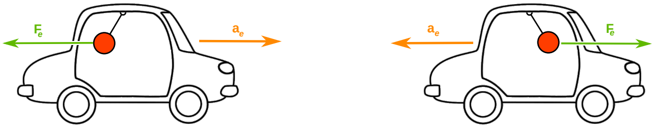
Fig. 1 – À gauche, une voiture (référentiel \mathcal{R}' ) qui accélère par rapport à la route (référentiel \mathcal{R} ) : les objets dans la voiture subissent une force d'entraînement \mathbf{F}_e = -m \mathbf{a}_e de sens opposé à l'accélération du référentiel de la voiture, qui les tire en arrière. À droite, la même voiture freine : l'accélération est de sens opposé (décélération), et cette fois la force d'entraînement tire les objets vers l'avant de la voiture.
