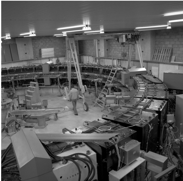
Fig. 5 – Anneau de stockage de muons au CERN, “g-2 Muon Storage Ring”, construit en 1974, utilisé notamment pour la mesure du moment magnétique “anormal” du muon (Photo CERN)
