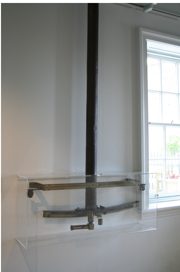
Fig. 1 – Secteur zénithal (téléscope pointant au zénith, permettant la mesure de la distance zénithale des étoiles). Conçu pour James Bradley, il est installé à l'observatoire de Greenwich. C'est avec cet instrument que J. Bradley découvrit l'aberration de la lumière et la nutation de l'axe terrestre (photos L. Le Guillou).
