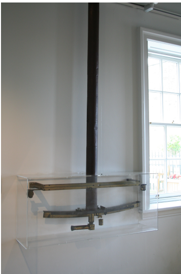
Fig. 6 – Secteur zénithal (téléscope pointant au zénith, permettant la mesure de la distance zénithale des étoiles). Conçu pour James Bradley, il est installé à l’observatoire de Greenwich. C’est avec cet instrument que J. Bradley découvrit l’aberration de la lumière et la nutation de l’axe terrestre (photos L. Le Guillou).
