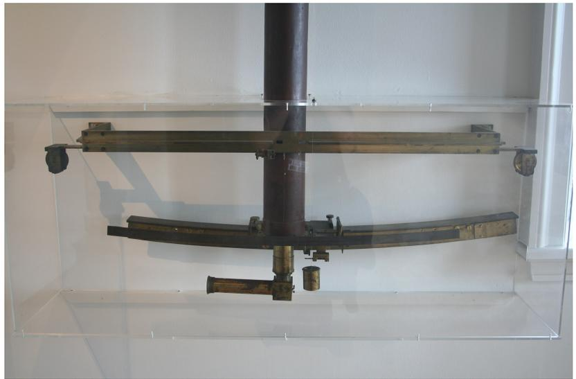
*Fig. 6 – Secteur zénithal (téléscope pointant au zénith, permettant la mesure de la distance zénithale des étoiles). Conçu pour James Bradley, il est installé à l’observatoire de Greenwich. C’est avec cet instrument que J. Bradley découvrit l’aberration de la lumière et la nutation de l’axe terrestre (photos L. Le Guillou).*
