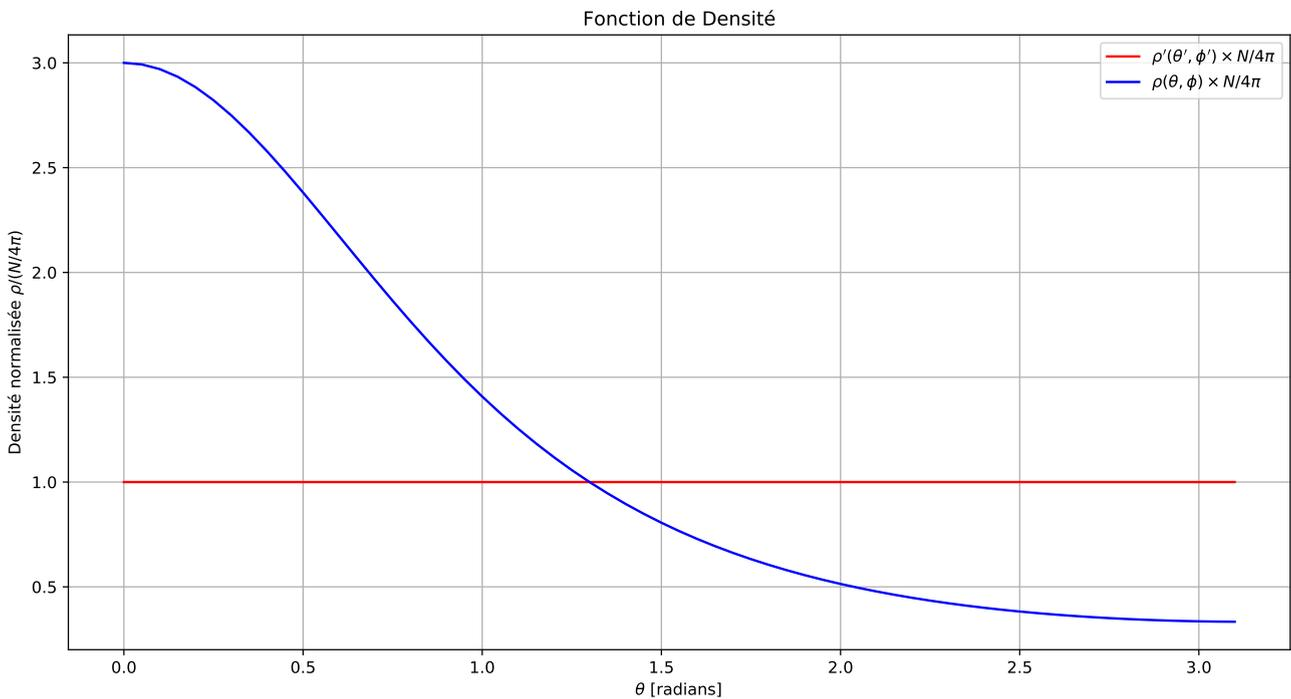
Fig. 3 – Effet “phare”. Fonction densité angulaire des rayons, dans le référentiel  $\mathcal{R}'$  de la source (rouge), et dans le référentiel  $\mathcal{R}$  où la source est animée d’une vitesse  $\mathbf{v} = v \mathbf{e}_x$  (bleu). Dans le référentiel  $\mathcal{R}$ , la densité des rayons est plus grande pour les petites valeurs de l’angle  $\theta$  et décroît quand  $\theta$  croît, ce qui correspond bien à une concentration des rayons vers l’avant dans le référentiel  $\mathcal{R}$ .
