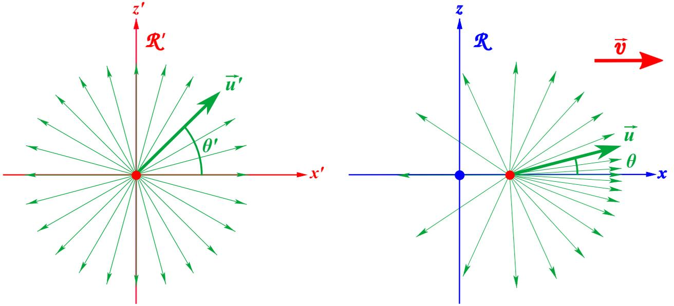
Fig. 2 – Effet “phare”. Dans le référentiel  $\mathcal{R}'$  de la source, les photons sont émis selon une distribution angulaire isotrope. Dans le référentiel  $\mathcal{R}$ , les rayons sont concentrés vers l’avant (effet projecteur ou effet phare) et le flux de photons émis par la source en mouvement est plus intense vers l’avant que vers l’arrière.
