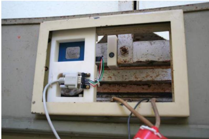
FIGURE 2.15 – Au premier plan l'antenne fixée. Au deuxième plan une puce et son support attachés à la partie mobile
