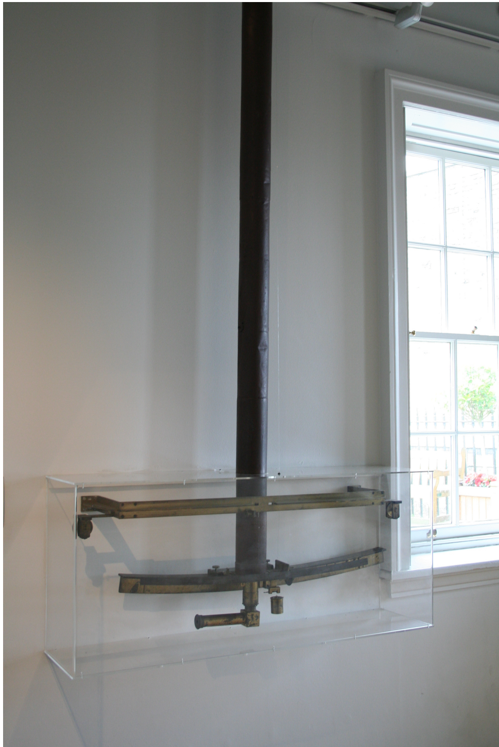
FIGURE 6 – Secteur zénithal (téléscope pointant au zénith, permettant la mesure de la distance zénithale des étoiles). Conçu pour James Bradley, il est installé à l'observatoire de Greenwich. C'est avec cet instrument que J. Bradley découvrit l'aberration de la lumière (1725) et la nutation de l'axe terrestre (photos LLG).
